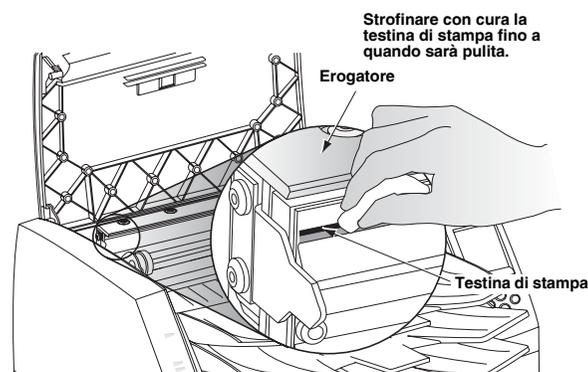
8. Utilizzando il fazzoletto per la pulizia della PRINT HEAD (Testina di stampa) in dotazione con il kit di pulizia del riproduttore di immagini, strofinare con cura avanti e indietro per l'intera larghezza della testina di stampa esercitando una pressione moderata. Il fazzoletto di pulizia potrebbe scolorirsi. Ripetere il movimento avanti e indietro fino a quando la testina di stampa è completamente pulita.
