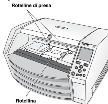
6. Utilizzando il panno per la PLATEN ROLLER (pulizia del rullo), contenuto nel kit di pulizia del riproduttore d'immagini, pulire ciascuna rotellina. Il fazzoletto di pulizia potrebbe scolorirsi.
