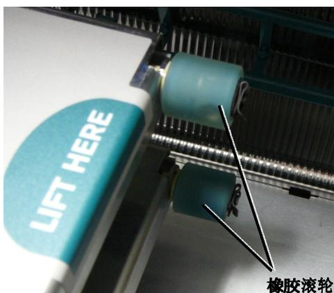
3. 使用白色滚筒清洁棉，擦拭每个滚轮周围。清洁棉可能会变色，必须确保擦除橡胶滚轮上所有起边或剥落的碎屑。用清洁棉用力的擦拭橡胶滚轮，直到所有碎屑都清除完毕。
